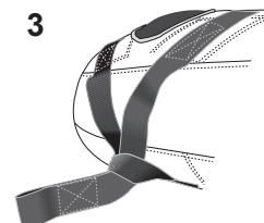
Remarque importante : Le système de traction doit toujours être utilisé selon les instructions de ce schéma. Si vous n'utilisez que la courroie supérieure ou inférieure pour tracter, la bouée ne fonctionnera pas correctement et risque d'endommager l'enveloppe ou la bouée. Toute détérioration causée par une utilisation incorrecte annulera votre garantie.
